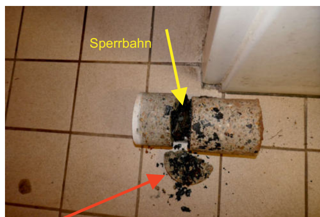
Bilder 31 und 32: Kernbohrung und Bohrkern Betonfußboden Eingangsbereich EG
