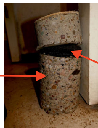
Bilder 31 und 32: Kernbohrung und Bohrkern Betonfußboden Eingangsbereich EG
